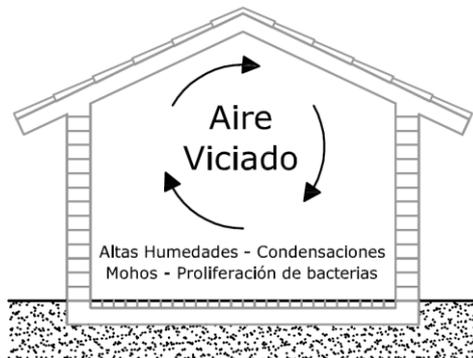
En una construcción levantada a base de cimento convencional, las paredes actúan como barrera al vapor de agua que evita que el edificio transpire y favorecen la creación de un clima de malestar pudiendo ser causa de varias enfermedades.
